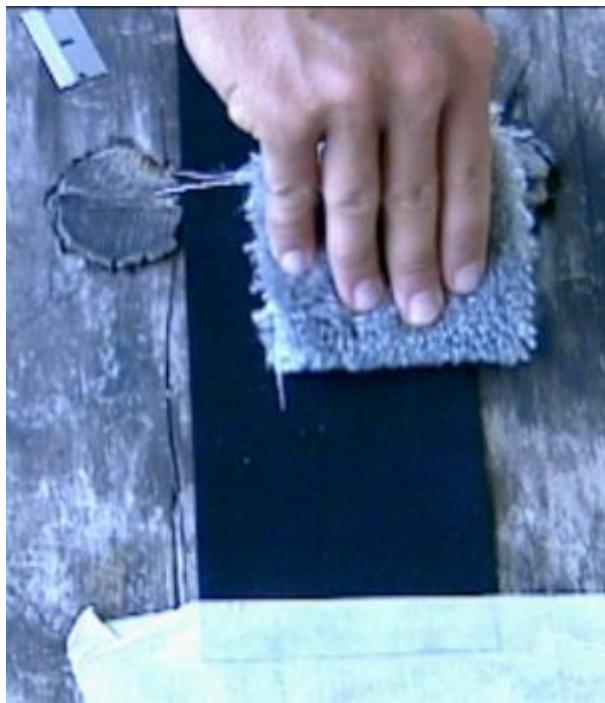
Нанесите ещё клея на этот же кусок ковролина, так чтобы он стал реально пропитанный kleem. Оберните им ветвь гика и протяните по всей длине от начала до конца. По мере движения плавно сдавливайте ковролин, чтобы выдавливался клей.
