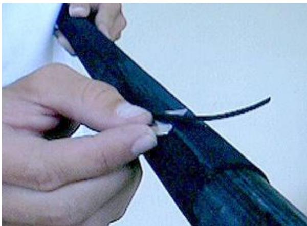
Обработайте срез наждачной бумагой № 80 до плавного перехода и маскировки шва.
